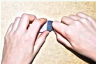
**1** Pose la pointe de l'aiguille (et seulement la pointe) sur l'aimant et frotte-la pour la magnétiser un peu (et ce, pendant toute la préparation).
